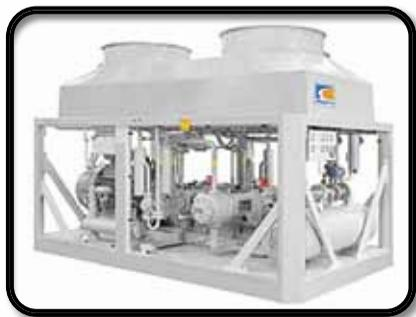
Las características del HF75-4-1, un compresor de tipo horizontal contrapuesto de 4 etapas, requiere de una presión de aspiración: 0,8 a 1,2 bar. Está refrigerado por aire y ofrece una potencia: 375kW (500HP). Entre sus detalles opcionales se destacan la cabina acústica, detector de gas, acumulador de aceite, protección para caños de alta temperatura, iluminación antiexplosiva, sensor de llama y de caudal de
