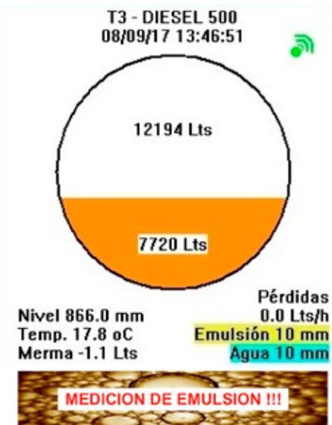
Se utilizan sondas de medición inalámbricas, que poseen Certificación de Seguridad Intrínseca del INTI-CITEI. Las mismas están construidas en acero inoxidable y materiales aptos para funcionamiento inmerso en combustibles.
