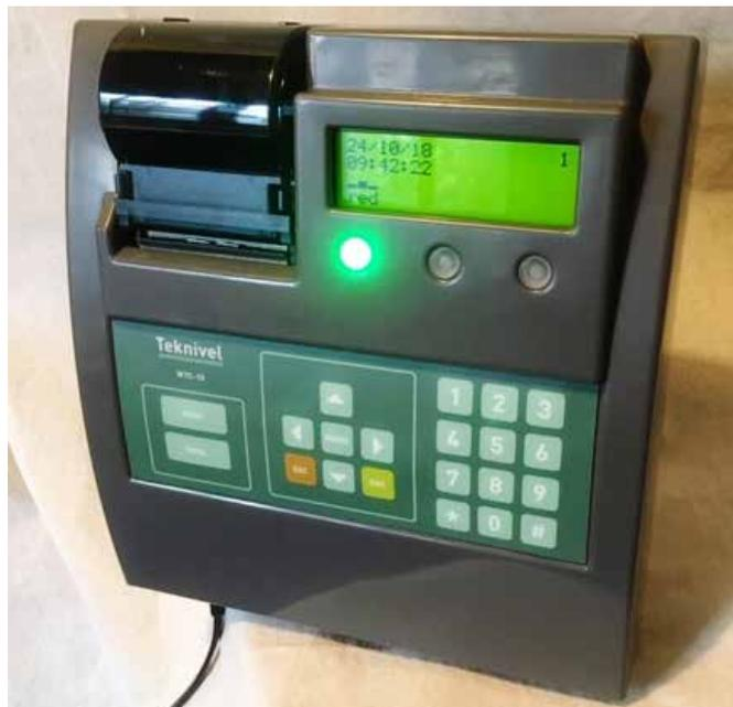
Es posible el control de toda la información desde lugares remotos, PC, Celular, etc. Los datos que se registran son: Nivel de combustible, Litros, Litros corregidos a 15 grados, Temperatura del producto, Pérdidas del tanque, agua precipitada y sus diluciones.
