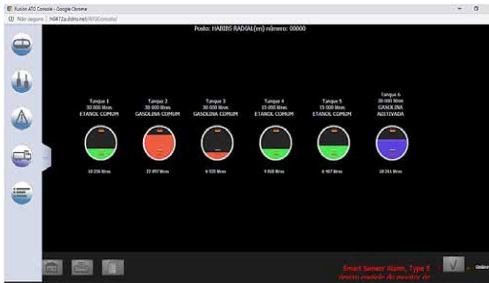
Conexión a PC con posibilidad de visualizar sus funciones en cualquier momento y desde cualquier lugar todo en tiempo real. Las Sondas OPW utilizadas para medición (Magneto restrictiva) incluyen cinco sensores de temperatura para mejorar la
