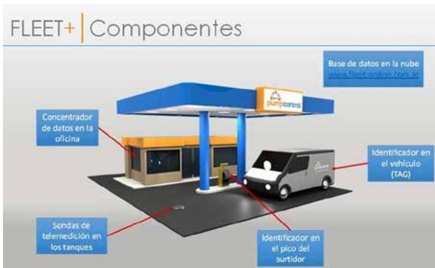
Además del control y el registro de cada despacho realizado, **Fleet Online** permite llevar un seguimiento minucioso del stock de combustible al integrarlo a la telemetración de tanques de combustible.
